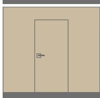
1. Верхняя часть проёма должна быть параллельна полу. Боковые стороны проёма должны быть параллельны между собой и перпендикулярны полу и верхней части проёма.
